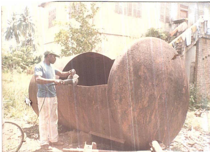
Figure 4. Récupération de tôle d'une ancienne citerne de station de carburants par le Chef de l'atelier CEPAM à Kpalimé au Togo
